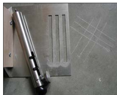
■ Figura 2. Durometro per sottofondi e valutazione della durezza superficiale.
