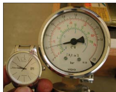
■ Figura 1. Determinazione dell'umidità con igrometro a carburatore.
