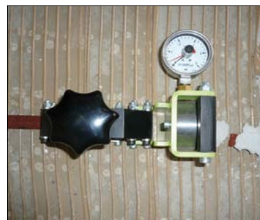
■ Figura 3. Misurazione delle sollecitazioni parallele al piano di posa.
